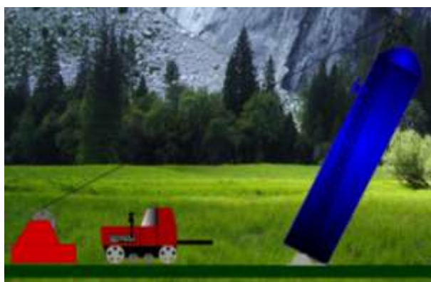
Рисунок 1 – Схема монтажа колонного аппарата методом поворота на шарнире
