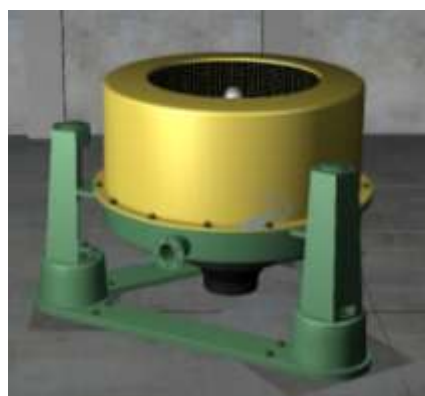
Рисунок 2 – Схема сборки трехколонной центрифуги
