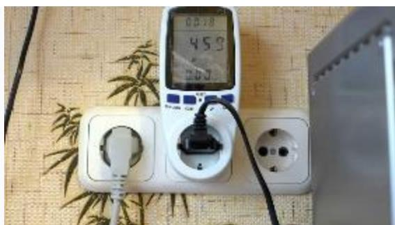
Ваттметр позволяет точно определить количество электричества
