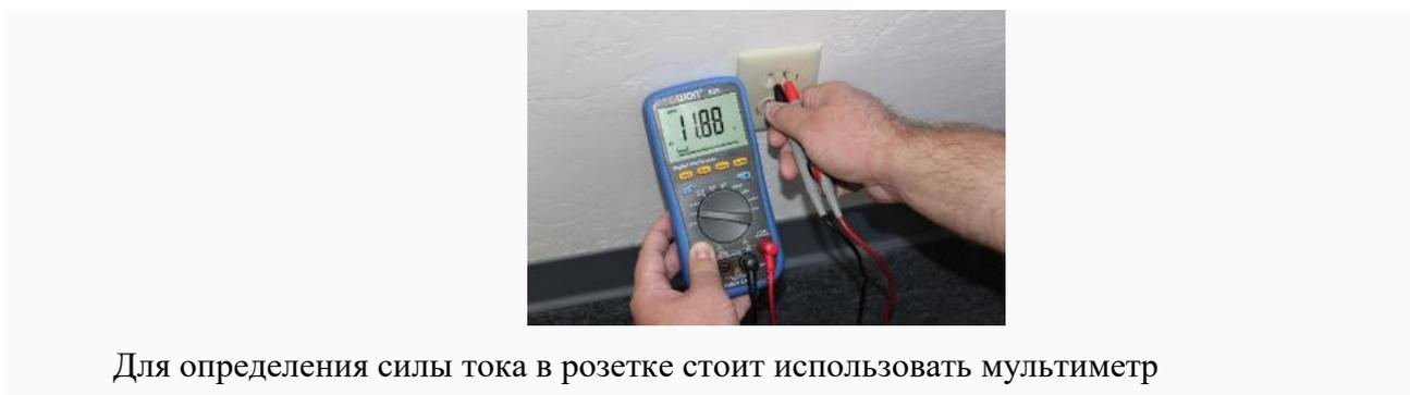
Для определения силы тока в розетке стоит использовать мультиметр
